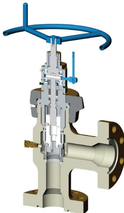
Технические характеристики регулируемых угловых штуцеров клеточного типа
