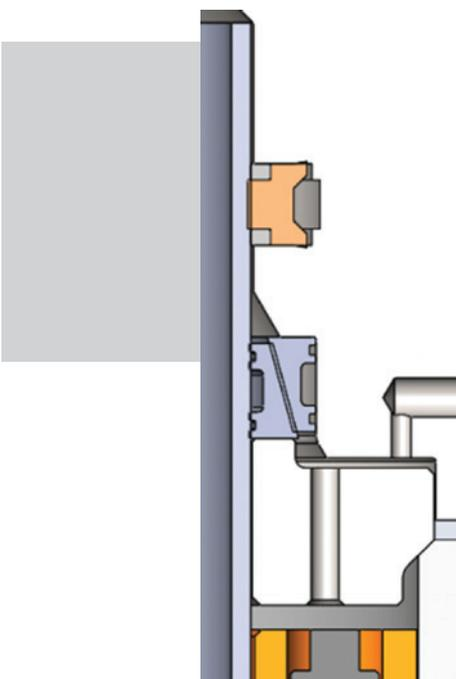
Вторичное металлическое уплотнение обсадной трубы.
