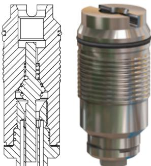
Клапан BPV двустороннего действия
