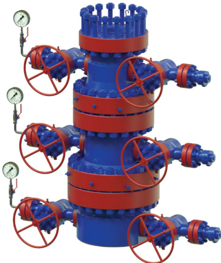
Двухфланцевая колонная головка предназначена для соединения с нижерасполагаемым оборудованием, закрепления (подвешивания) верхнего конца обсадной колонны в трубодержателе, герметизации межколонного пространства снизу вторичным уплотнением и сверху первичным уплотнением.
