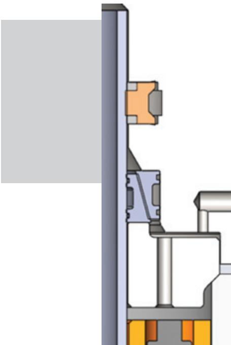
Вторичное металлическое уплотнение обсадной трубы.
