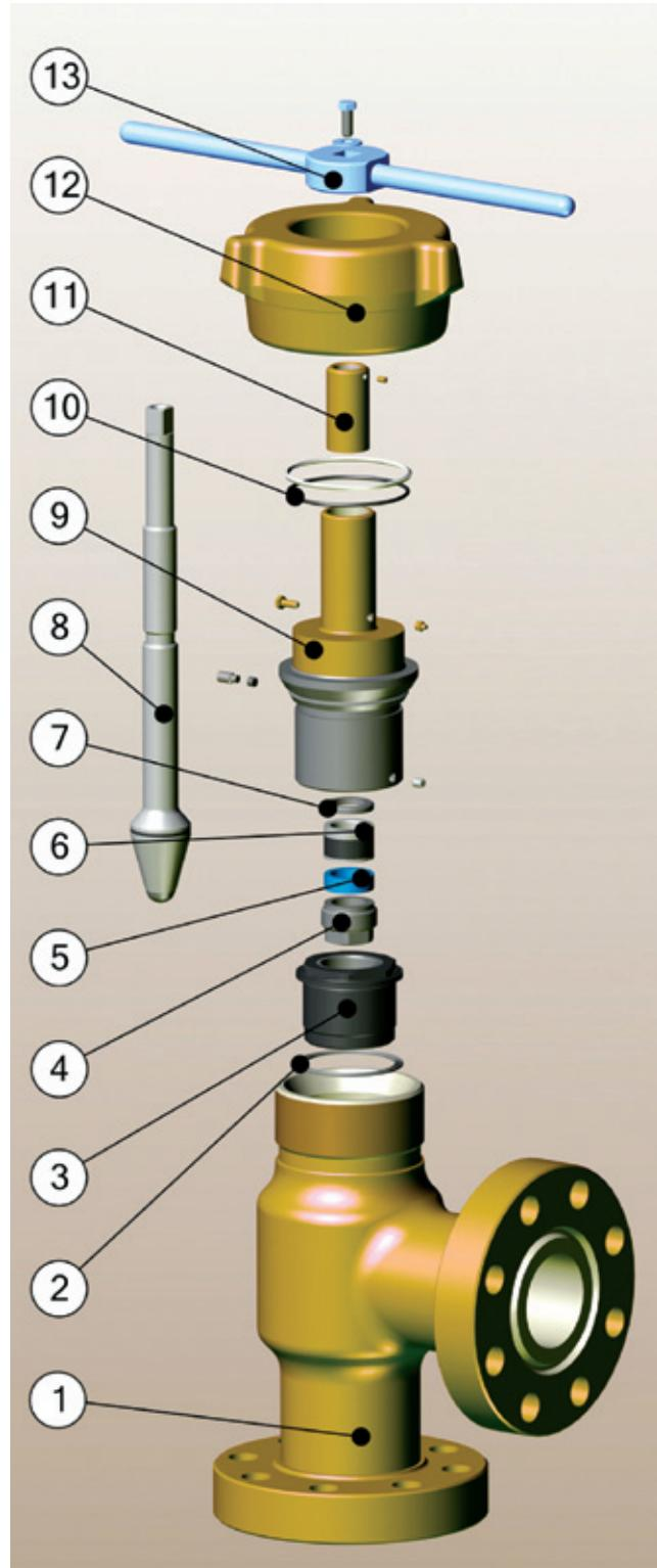
Технические характеристики регулируемых угловых штуцеров игольчатого типа
