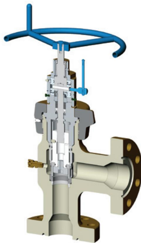
Технические характеристики регулируемых угловых штуцеров клеточного типа
