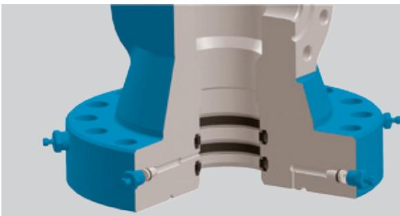
Вторичное уплотнение обсадной трубы с двумя П-образными манжетами.
