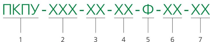
**1** – Буквенное обозначение типа предохранительной арматуры
