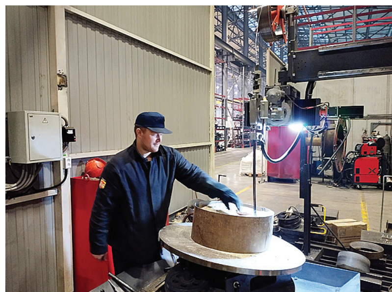
Наплавщик Владимир Булкин выполняет работы по наплавке клина
